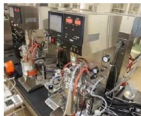
流加培養用 5Lx4連培養槽
