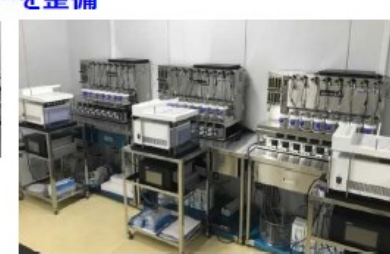
スクリーニング・条件出し用 0.25L x24連培養槽
