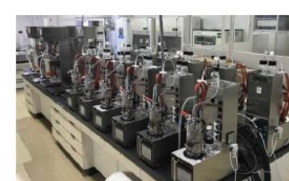
教育・小規模流加用 1Lx12連 培養槽
