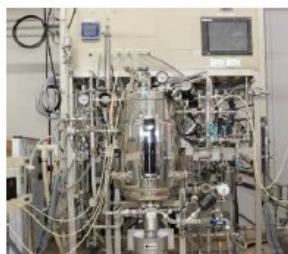
30L蒸気滅菌型培養槽
